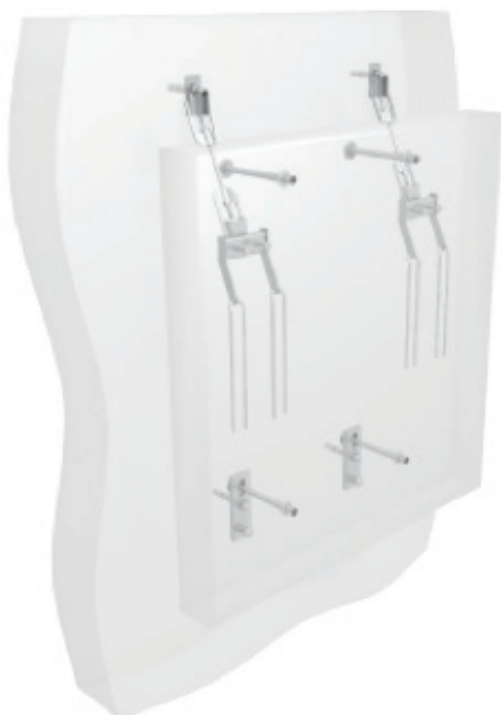
Univerzita Palackého v Olomouci - kotvení fasády s lezeckou stěnou.
